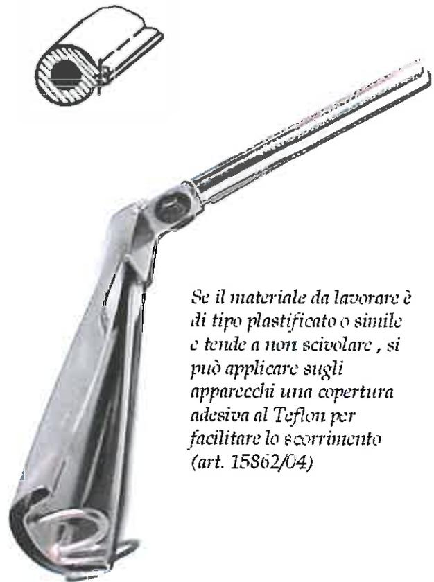
*Se il materiale da lavorare è di tipo plastificato o simile e tende a non scivolare, si può applicare sugli apparecchi una copertura adesiva al Teflon per facilitare lo scorrimento (art. 15862/04)*
