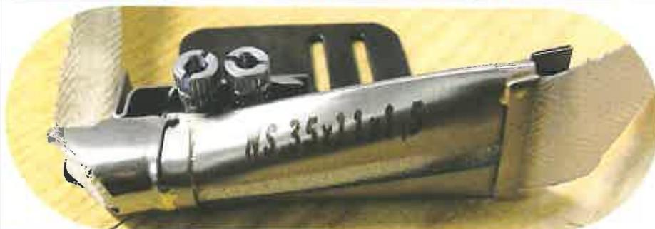
*Bordatore a 90° a taglio vivo speciale con invito in lamierino inox per agevolare il nastro al suo passaggio. Completo di staffa di fissaggio e guida*
